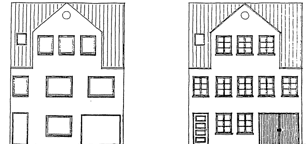
Fig.2. Eksempel på, hvordan man i forbindelse med en modernisering har bragt vinduer og døre i harmoni med bygningen.
