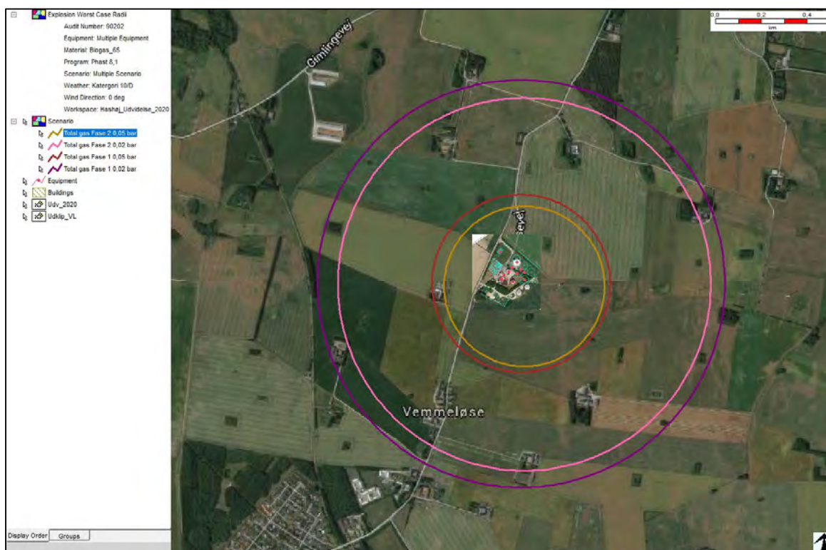
Figur 3-32: Område, der vil være udsat for udvalgte eksplosionsovertryk ved eksplosion af alt tilstedeværende gas.
