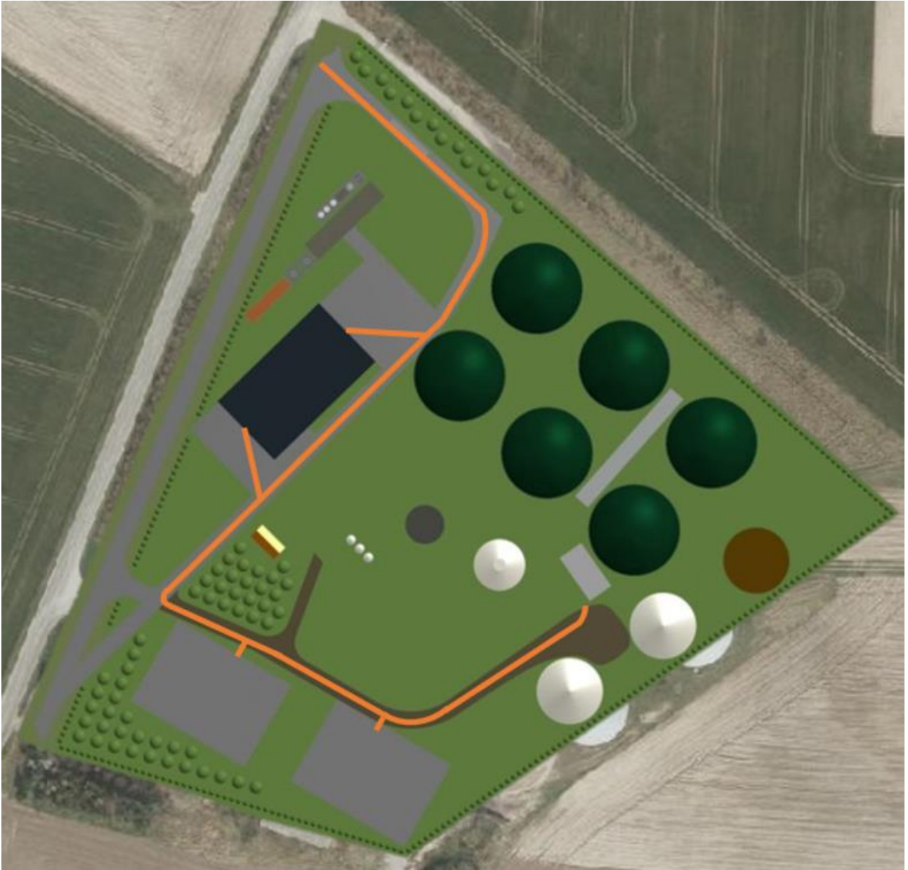
Bilag 11. Interne køreveje, Hashøj Biogasanlæg
