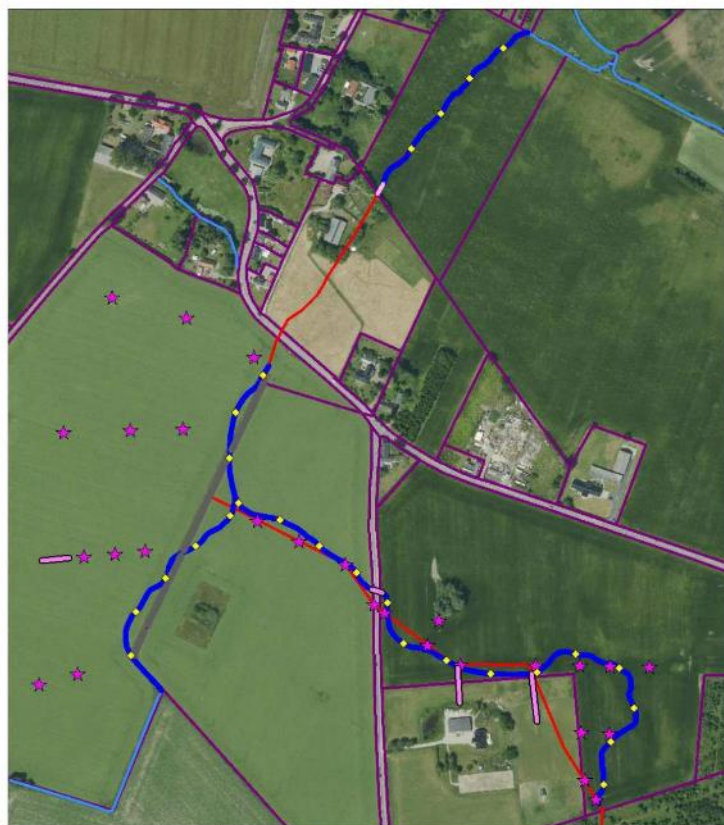
Figur 17. Projektforslaget for Slagstrupbækken vist med bestående vandløb og grøfter i lyseblå streg, hovedledninger i rød streg, matrikelskel i lilla streg, nye åbne vandløb i fed mørkeblå streg, station i vandløb per 50 m med gule romber og nye rørledninger i pink streg, afbrudte rør med lyslilla stjerner og tilfyldte grøfter med mørkegrå streg i skala 1:6.000 på baggrund af DDO ® 2022 fra maj 2022, ©Hexagon.
